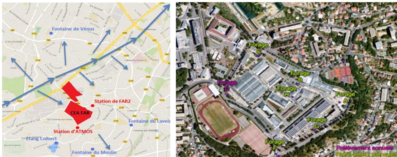
**Figure 23** – Sens d'écoulement de la nappe et implantation des piézomètres
