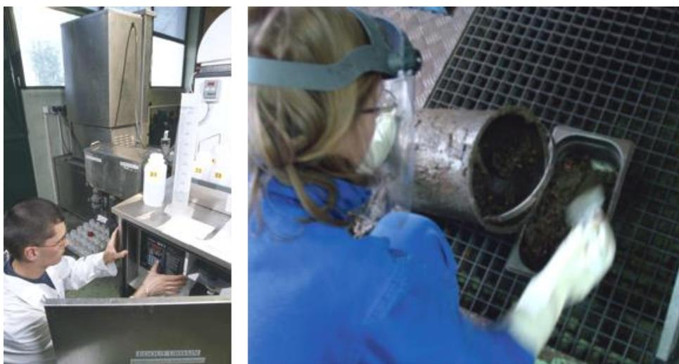
**Figure 4** - Surveillance en continu des émetteurs  $\beta\gamma$  de l'égout urbain et prélèvement de boues
