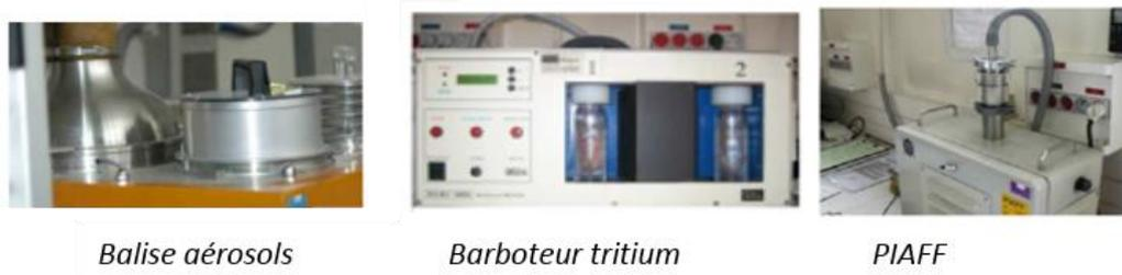
**Figure 7** - Appareils de surveillance atmosphérique
