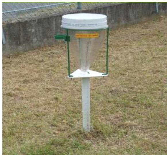
**Figure 21** - pluviomètre 0,04  $\text{m}^2$  à lecture directe
