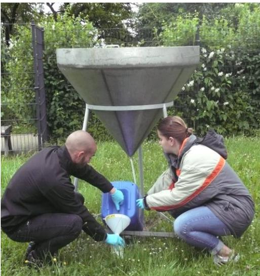
**Figure 20** - Pluviomètre 1  $\text{m}^2$
